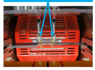
AUTOMATED GUIDE ARMS POSITION TUBING INTO PLACE FOR THE HEAT CYCLE TO BEGIN
