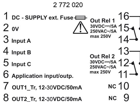
VDC 2 Relais / 2 Transistoren
