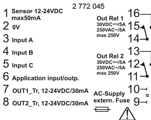
VAC Trafo 2 Relais / 2 Transistoren
