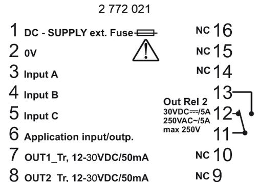
VDC 1 Relais / 2 Transistoren
